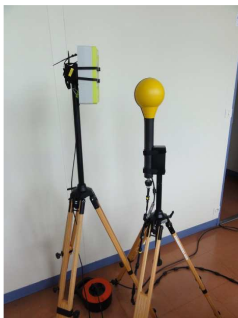
Compteur Linky et sonde de mesure installés sur des trépieds pour les tests en laboratoire
