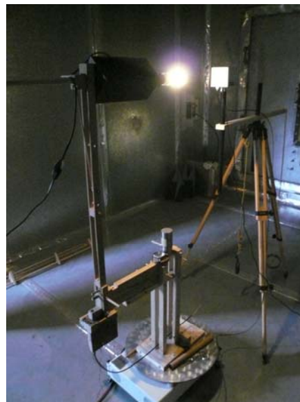
Figure 6.4.1 : Positionnement de la lampe et recherche de la direction d'émission maximale
