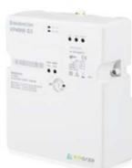
**2 Le data concentrateur** constitue le nœud de communication entre le réseau Moyenne Tension (HTA) et le réseau Basse Tension (BT). Il relaie les données et commandes émanant du système d'information SOGRID, et les exécute auprès des compteurs, en utilisant le CPL (courant porteur en ligne). *Développement Sagemcom.*
