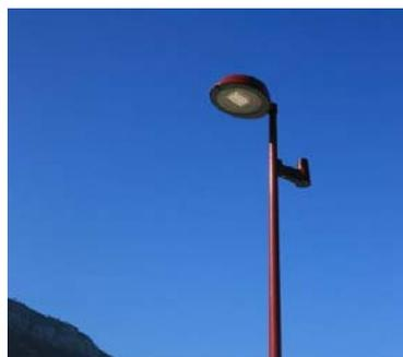
Pour adapter automatiquement l'éclairage public de la voie piétonne et cyclable de Vif (Isère) et réduire ainsi les consommations électriques tout en préservant la sécurité des habitants, la ville et ETDE ont opté pour une solution intelligente de détection de présence et d'utilisation de luminaires LED, tout en ajustant les puissances aux besoins des niveaux d'éclairage.
