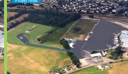
*Réduction des capacités de stockage, suppression des sphères, déplacement des zones de chargement/déchargement, création d'un réservoir haute sécurité de 600m<sup>3</sup>*
